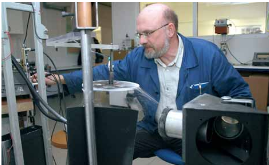
Pavel Pokorný u univerzálního rámu, kde výzkumný tým poprvé objevil u nanovláknenných materiálů RTG záření. Nyní se na přístroji provádějí měření tzv. relaxačního času při zvláknování polymerů
