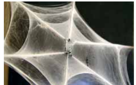
Nanovláknenná vrstva na univerzálním rámu demonstruje možnosti depozice a orientace nanovláken na speciálních kolektorech.
