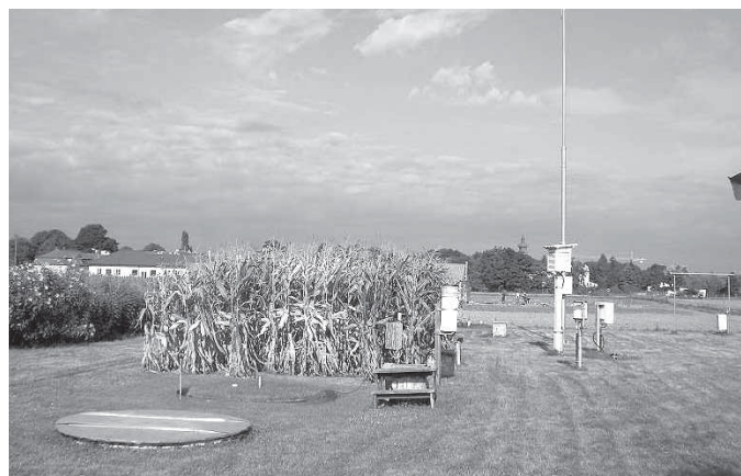
Obr. 2. Meteorologická stanice a váhové lyzimetry v Gross-Enzersdorfu
